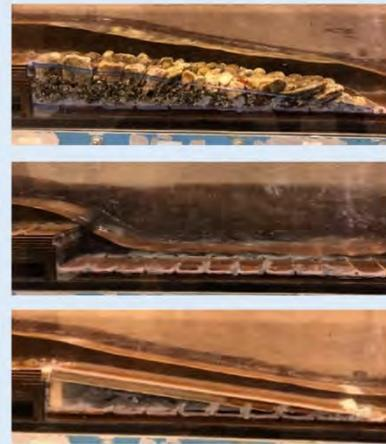
福岡県朝倉市秋月地区を流れる野鳥川には石積みによる伝統堰が現存している。本研究では既往最大降雨時を想定した水理模型実験によりその減勢機能を定量的に評価した。その結果、石畳堰によって流速が減勢され、護岸が空石積みであっても耐久可能となることを示した。
