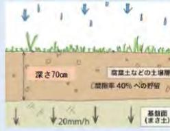
屋根から繋がる樋を切断し、敷地内の雨水を庭の土壌へ浸透・貯留
