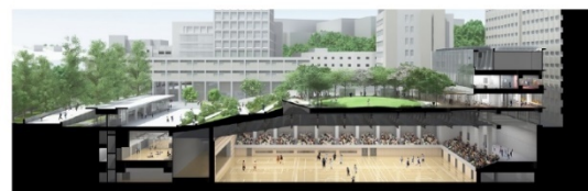
「戸山の丘」は平均土厚約100cm・最大土厚約230cmの植栽基盤を持つ「第二の大地」とも言える環境
